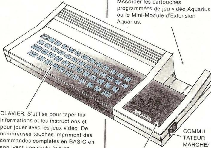
**CLAVIER.** S'utilise pour taper les informations et les instructions et pour jouer avec les jeux vidéo. De nombreuses touches impriment des commandes complètes en BASIC en appuyant une seule fois en conjonction avec la touche CTL (Contrôle).
